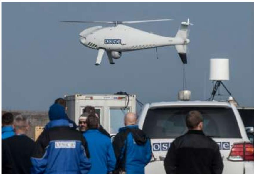
*Рис. 1. (А) БПЛА дальнего действия, используемый СММ, как с электрооптической (видимый свет), так и с инфракрасной (тепловизионной) камерой в отсеке (шар внизу). (Источники изображений)<sup>31</sup>*
